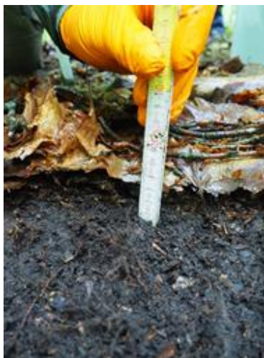
rys. 4. Pomiar miąższości poziomu organicznego gleb mineralnych
