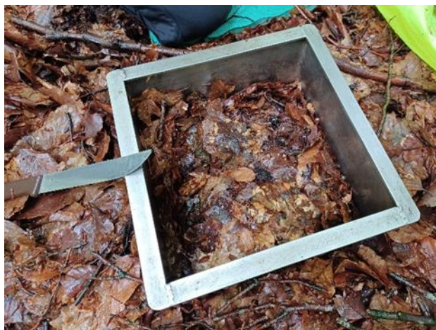
rys. 3. Ramka do poboru poziomów organicznych
