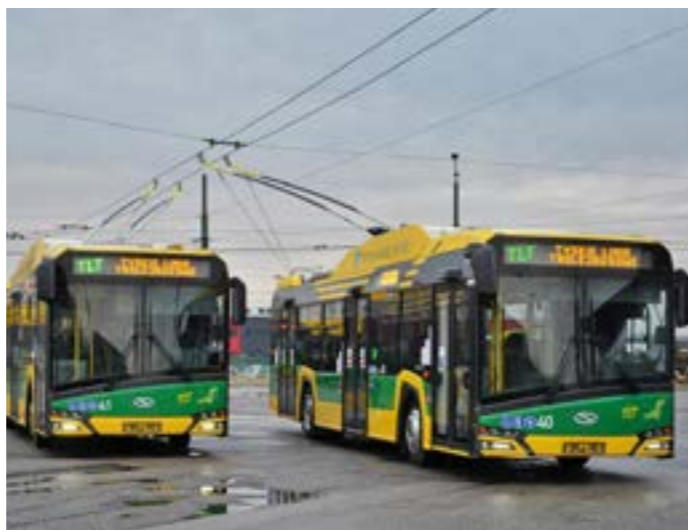
Nowoczesne trolejbusy z dodatkowym napędem bateryjnym
