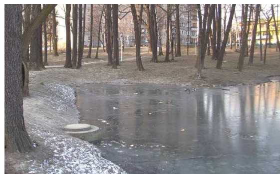
Studnia piętrząca wodę w stawie, skąd woda odpływa rurociągiem do drugiego stawu
