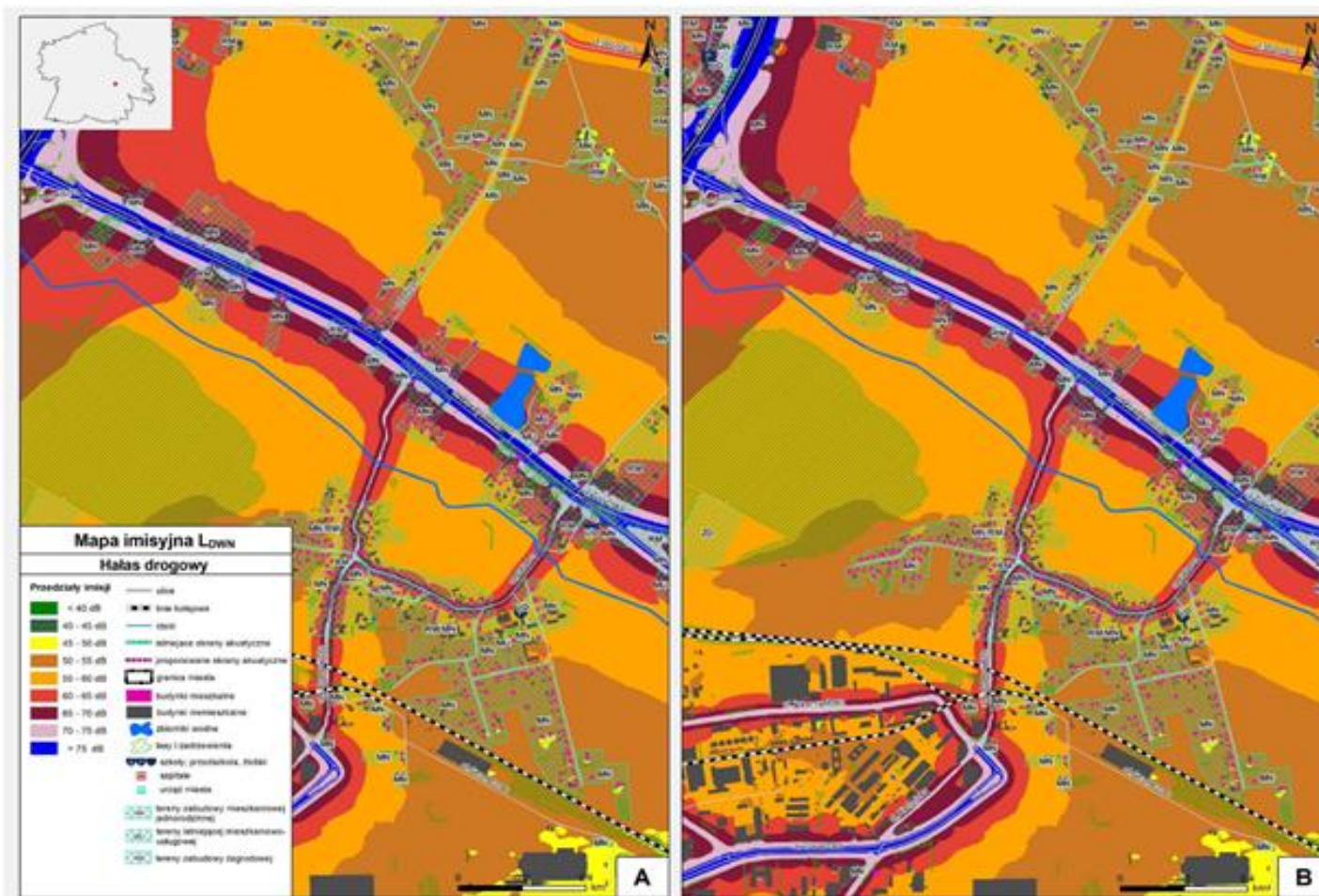
Rys. 3. Sytuacja przed (A) i po (B) zastosowaniu proponowanych działań ograniczających emisję hałasu do środowiska na ul. Oświęcimskiej.
