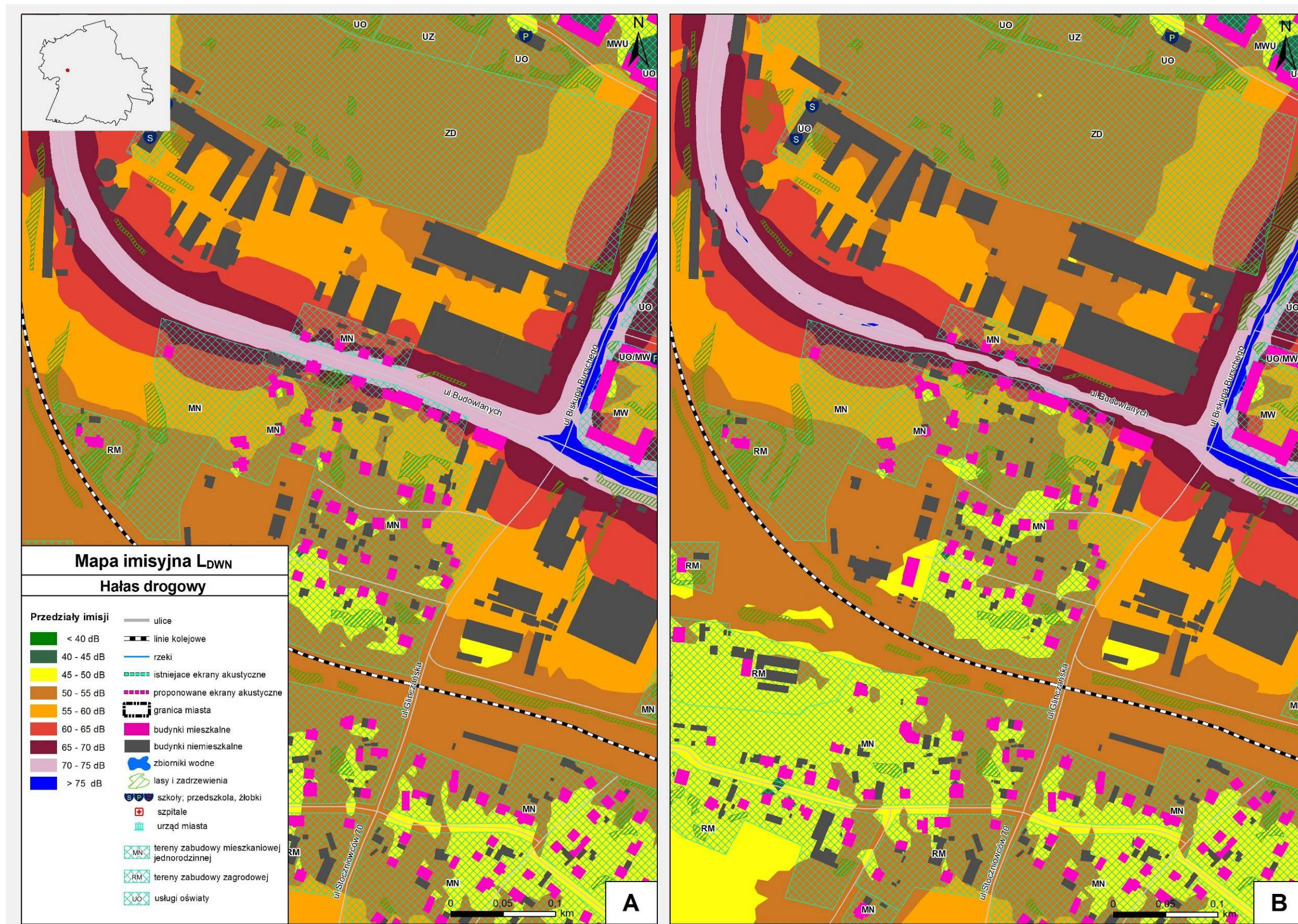
Rys. 4. Sytuacja przed (A) i po (B) zastosowaniu proponowanych działań ograniczających emisję hałasu do środowiska na ul. Budowlanych.
