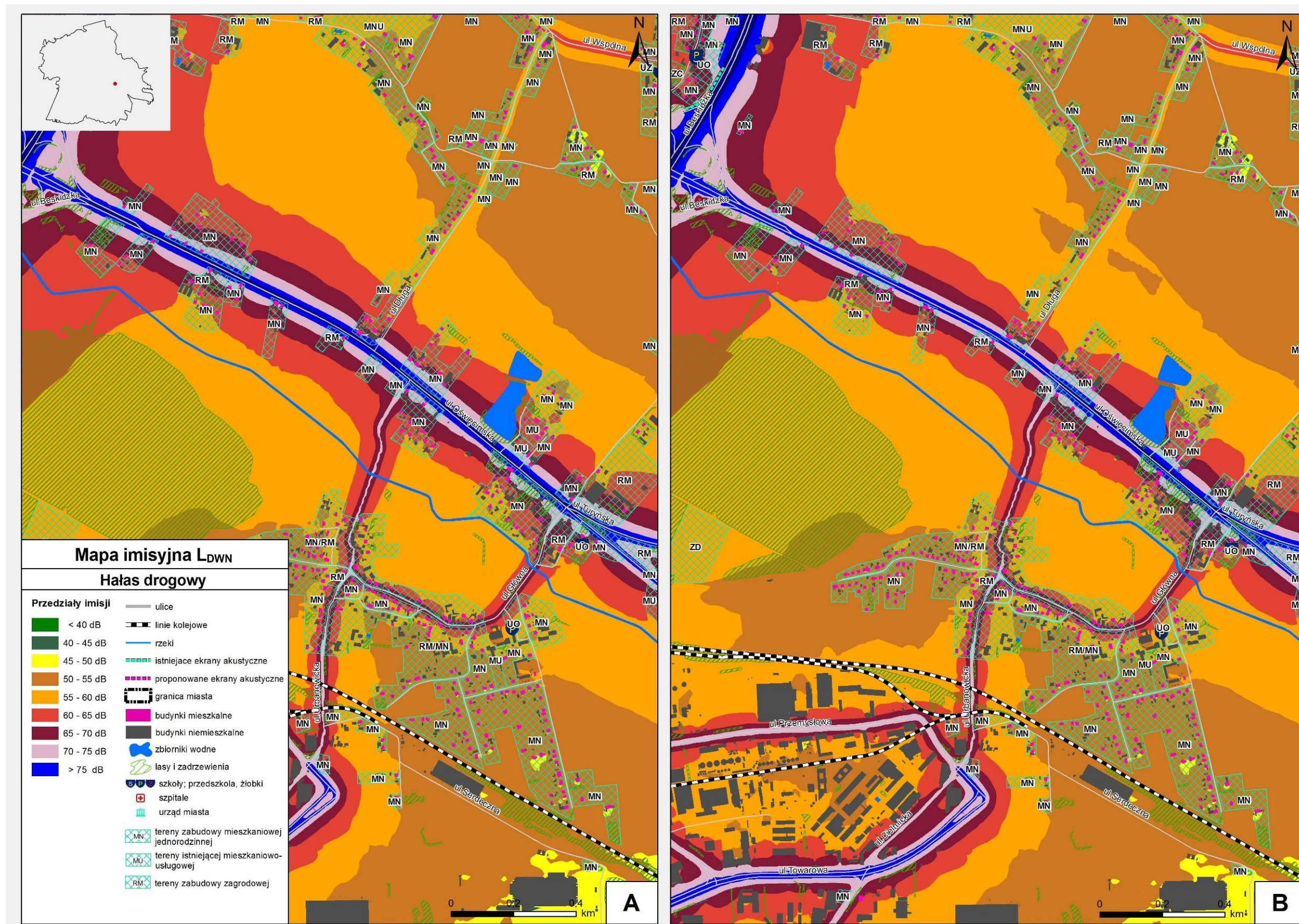
Rys. 3. Sytuacja przed (A) i po (B) zastosowaniu proponowanych działań ograniczających emisję hałasu do środowiska na ul. Oświęcimskiej.
