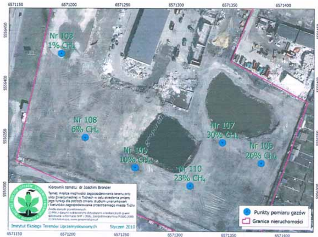
Rys. 8. Mapa punktów pomiaru zawartości gazów wysypiskowych. Wyniki pomiaru metanu
