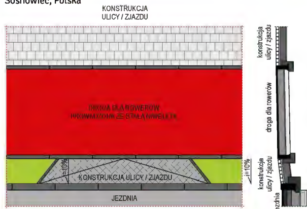
Rysunek 9 Schemat prowadzenia drogi dla rowerów przez zjazdy oraz ulice podporządkowane
