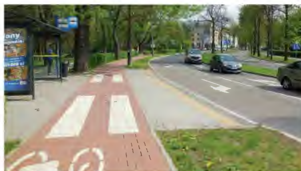
Zdjęcie 21 Droga dla rowerów pomiędzy obszarem wsiadania a chodnikiem (Uwaga: niewłaściwa nawierzchnia drogi dla rowerów)
