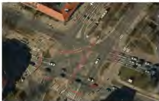
Zdjęcie 52 Ukośny przejazd rowerowy. Polska, Wrocław
