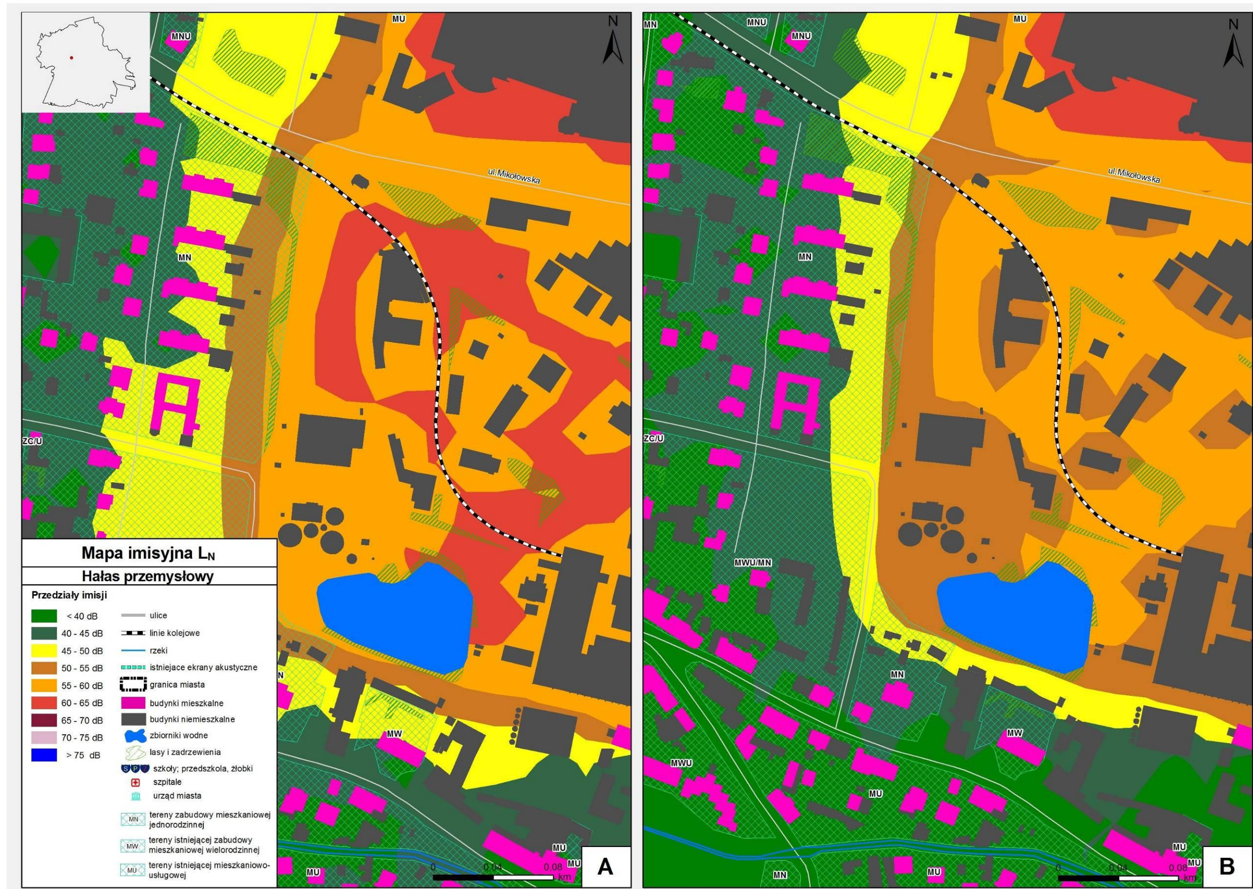
Rys. 6. Sytuacja przed (A) i po (B) zastosowaniu proponowanych działań ograniczających emisję hałasu do środowiska przy zakładzie Tyskie browary Książęce .
